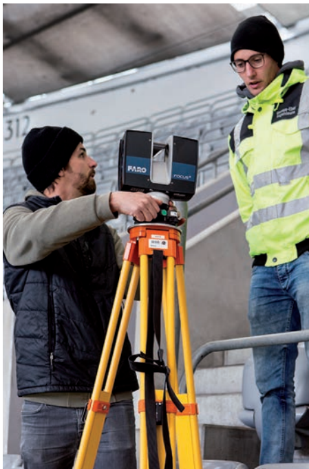
Aufmaß der Stahlträger mit unserem Laserscanner Faro Focus S 150.
